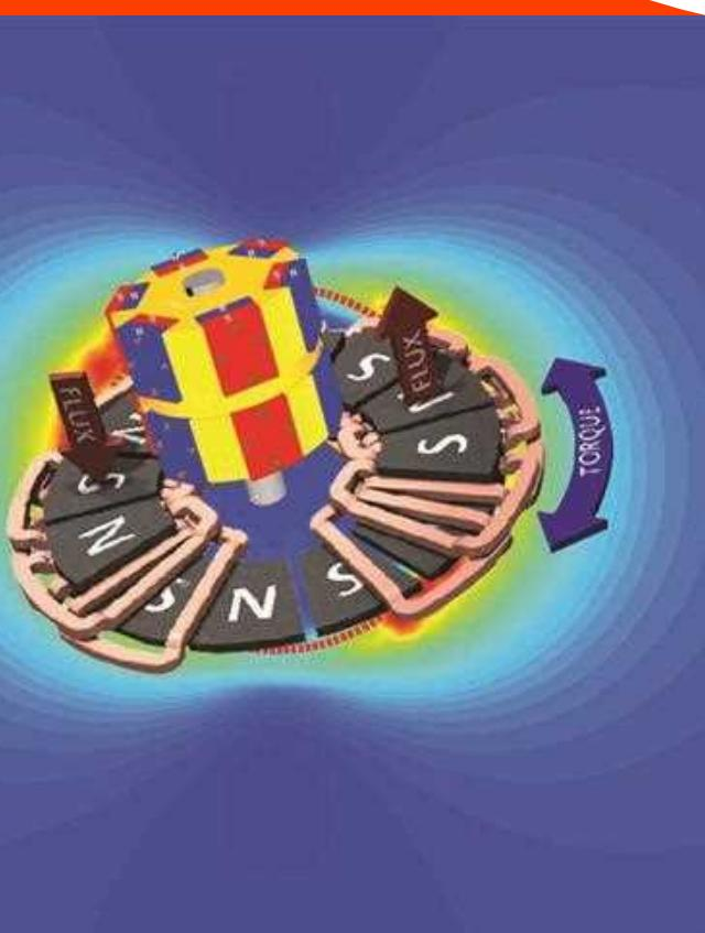
Generator listrik adalah alat yang memproduksi energi listrik dari sumber energi mekanik, menggunakan induksi elektromagnetik. Generator konvensional meningkatkan produksi daya listrik dengan menambah kecepatan putaran atau menambah kumparan penghantar yang memotong garis gaya listrik (GGL).
